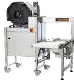
SMG 75i Mit integrierter Förderung für vollautomatischen Betrieb
